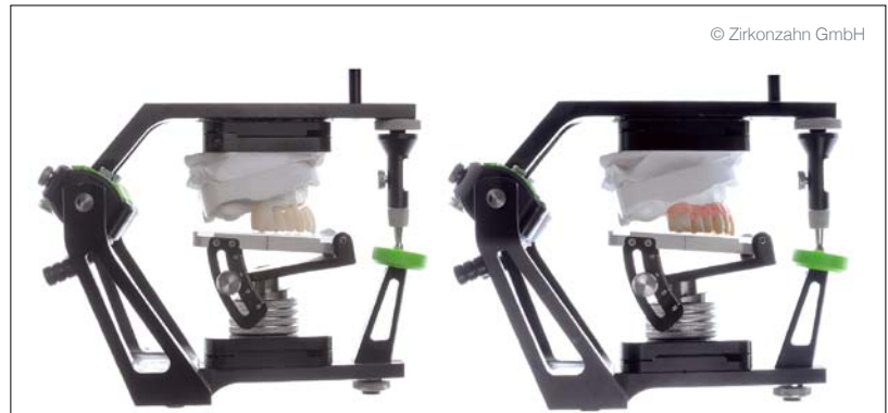
图 22: 在制作新义齿时可以随时在 PS1 殆架上检查义齿殆平面是否正确。
